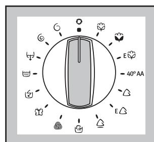
Положение **E** означает «энергосберегающая программа» для белого и цветного белья, положение **O** означает возможность выбора новой программы или отключение электропитания. По окончании программы селектор следует повернуть в положение **O**, чтобы отключить электропитание машины.
